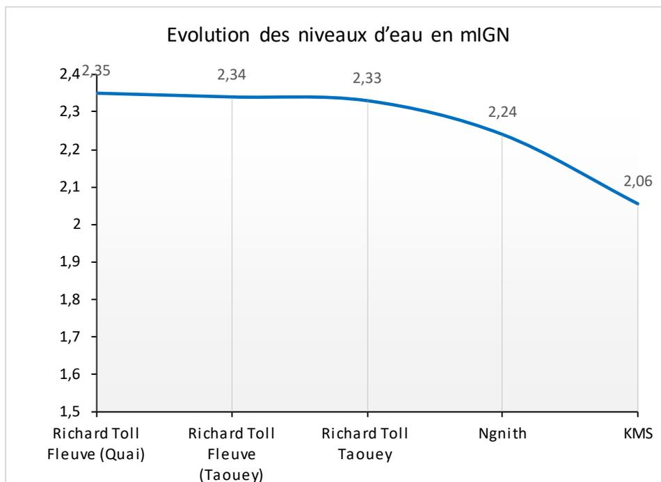
Du 1<sup>er</sup> au 21 août 2025, un volume de 1,92 milliard de m<sup>3</sup> a été lâché à l'ouvrage de Diama.
